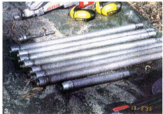
Set di aste di carotaggio. Sono visibili anche la testa di perforazione montata ed il raccordo.
