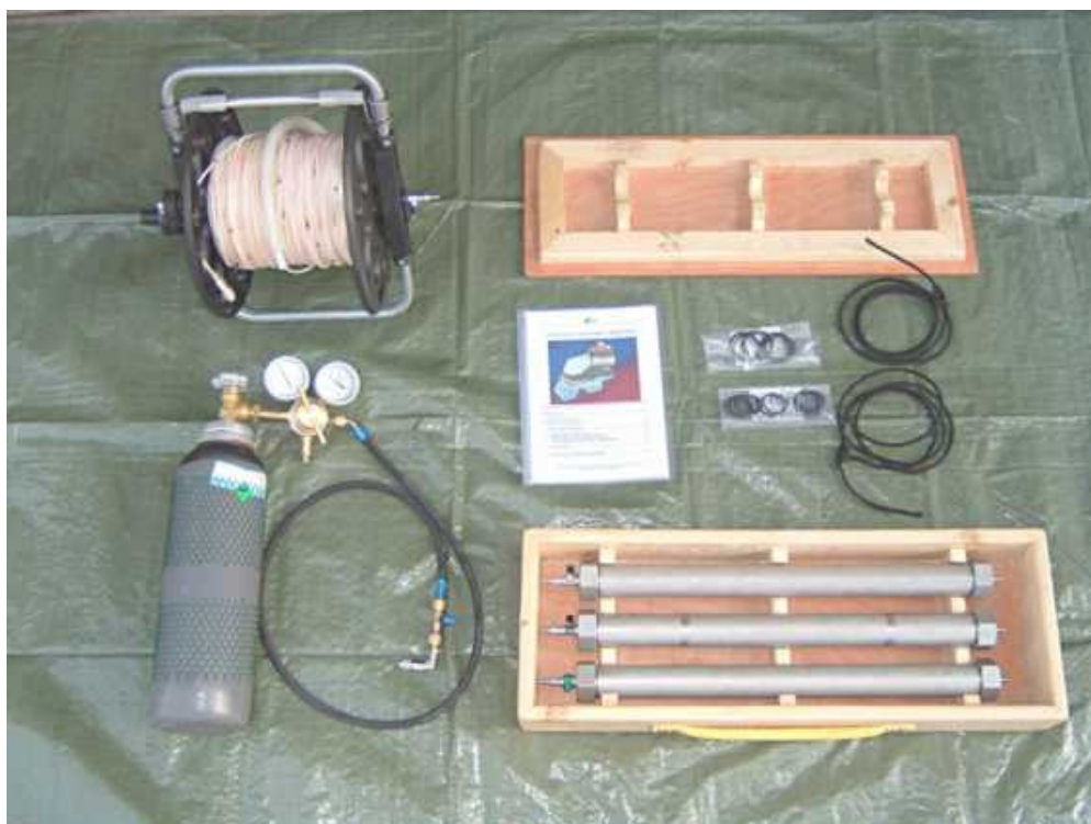
Campionatore pneumatico AF per fluidi profondi – Attrezzatura completa. Sistema di calamento, campionatore acqua pneumatico, sistema di pressurizzazione
